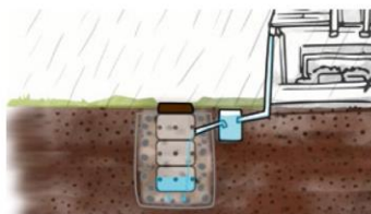
Le puits d'infiltration
